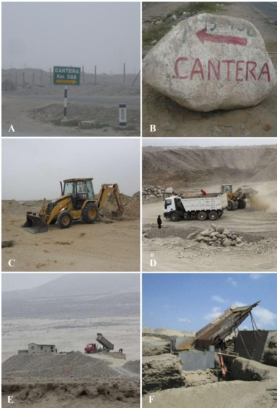
**Figura 1.** A-B. Letreros que indican el ingreso a las canteras de extracción, C. Cargador frontal y retroexcavadora, D. Cargador frontal y volquete extrayendo gravilla y arena, E. Volquete acumulando el material extraído, F. Tamizador de material.
