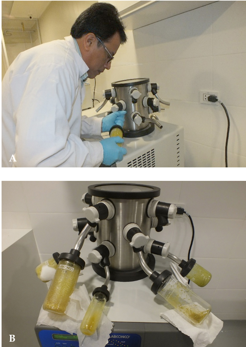
Fig. 5. Muestras finalizando el proceso de liofilización.
