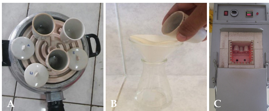
Fig. 6. A. Cenizas totales obtenidas más 10 mL de agua destilada en ebullición; B. Se filtró a través de papel filtro libre de cenizas; C. Papel filtro con el residuo incinerado en horno mufla a 700 - 750 °C.
