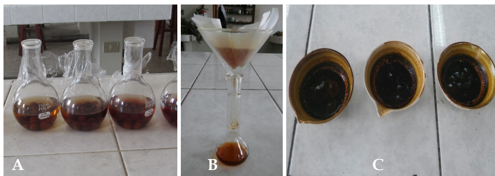
Fig. 13. A. Se dejó macerar 100 g de frutos enteros frescos más 150 mL de etanol 96 °GL acidificado con ácido cítrico al 0.1%; B. Se filtró obteniéndose el extracto etanólico acido; C. Se concentró hasta obtención de extracto blando.
