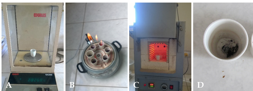
Fig. 5. A. Se pesó 5 g de fruto fresco entero; B. Se carbonizó la muestra; C. Se incineró en un horno mufla a 700 °C; D. Muestra incinerada.
