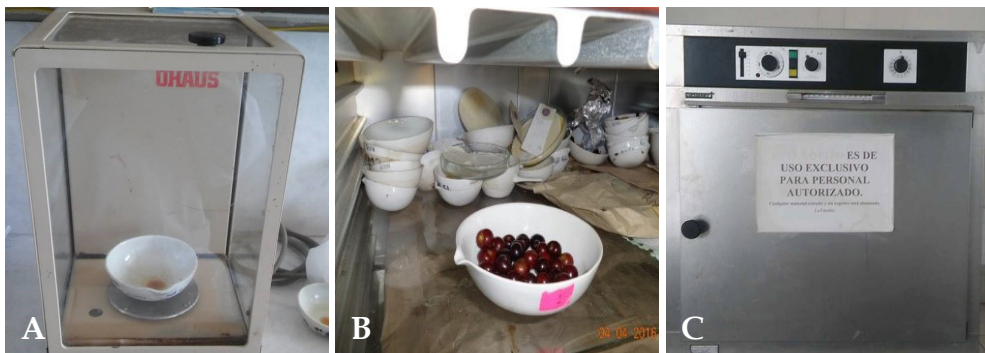
Fig. 4. A. Se pesó 5 gramos de fruto; B. Humedad relativa: Se llevó a 40 °C y se registró el peso; C. Humedad residual: Se llevó la muestra a 105 °C y se registró el peso.
