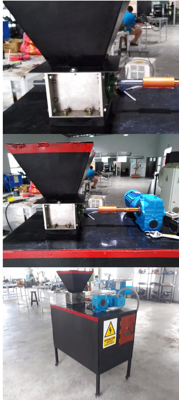
Figura 11. Máquina trituradora de PET desarrollado en este trabajo.
