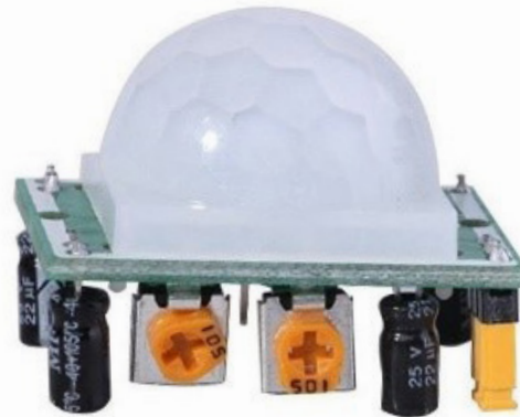
Figura 6 – Sensor PIR. Recuperado de https://www.makeelectronico.com/producto/sensor-movimiento-pir-hc-sr501/
