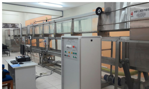
Figura 1: Canal de pendiente variable Fuente: Laboratorio de Hidráulica y Mecánica de Fluidos de UPAO (2017)
