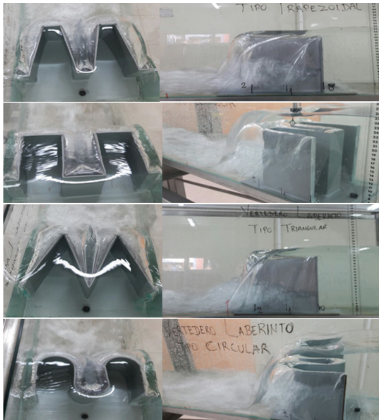
Figura 7. Vista en planta y frontal de los vertederos laberinto trapezoidal, triangular rectangular y circular.
