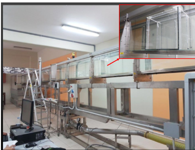
Figura 1. Canal de Pendiente Variable H91.8D con Prototipo
