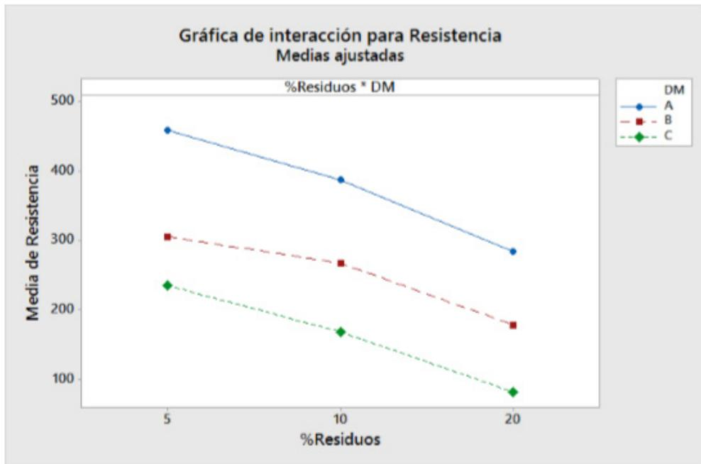
Figura A-2. Gráfica obtenida con el Minitab, interacción de % residuos y diseño de mezcla (A: concreto contenido plástico PET, B: concreto conteniendo bagazo de caña de azúcar y C: concreto conteniendo papel)
