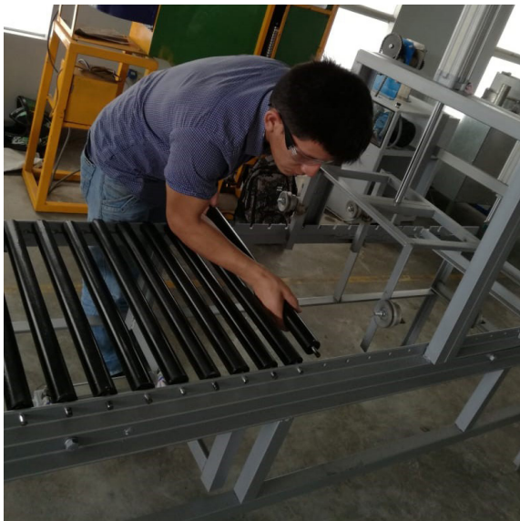
Figura. 4. Sistema de polines que permite transportar la masa de arcilla húmeda.
