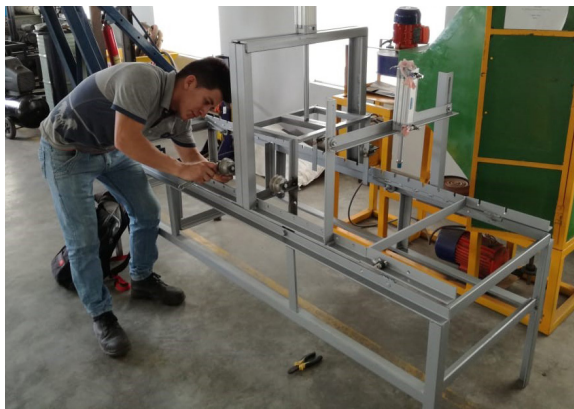
Figura. 2. Estructura soporte de la máquina de cortar de arcilla húmeda para fabricación de ladrillo.
