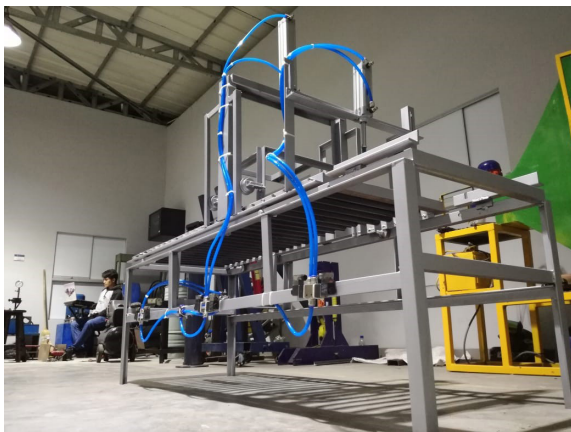
Figura. 5. Sistema de electroneumática del equipo desarrollado en el proyecto.
