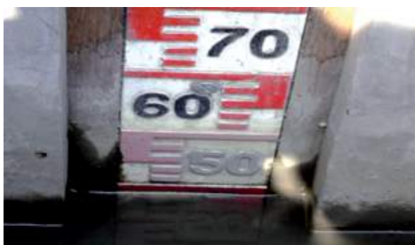
Figura 9. Estructura de aforo donde se observa que el tirante actual es de 0.49 \text{ m} .
