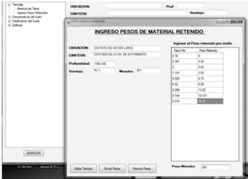
Figura 9: Ingreso de datos para el análisis granulométrico.
