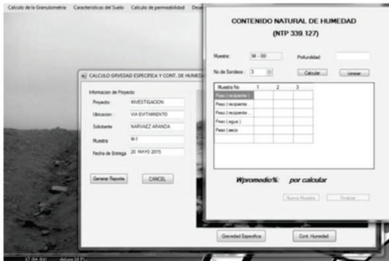
Figura 10: Contenido natural de humedad, LL y Lp
