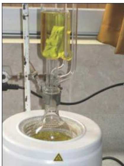
Figura 8. Recuperación de aceites a partir de la biomasa seca de Scenedesmus spp. a través del método de Soxhlet.
