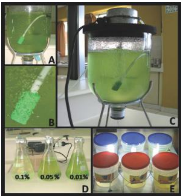
Figura 2. Crecimiento de Scenedesmus spp. en biorreactor tanque agitado, bajo condiciones de laboratorio. A) Detalle del sistema de aireación acondicionado a biorreactor de 4 Lt de capacidad. B) Piedra difusora asperjando aire estéril dentro del bioreactor. C) Biorreactor completamente ensamblado para las lecturas de crecimiento. D) Crecimiento de Scenedesmus spp en matraces de 1 Lt bajo diferentes concentraciones de Nitrofoska Verde®, los cuales fueron sembrados de forma paralela. E) Cultivo en recipientes de 4 Lt de capacidad.
