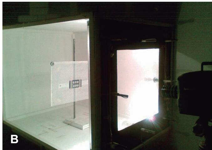
Figura 2. (A) Aparato de reflexión espectrofotométrica "luminanciómetro espectral" (Spectra Scan System modelo PR 715, Photo Research). (B) Lugar para medición de color y translucidez.
