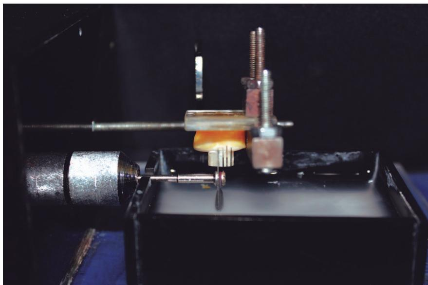
Figura 3. Obtención de especímenes en máquina de cortes tipo IsoMet.
