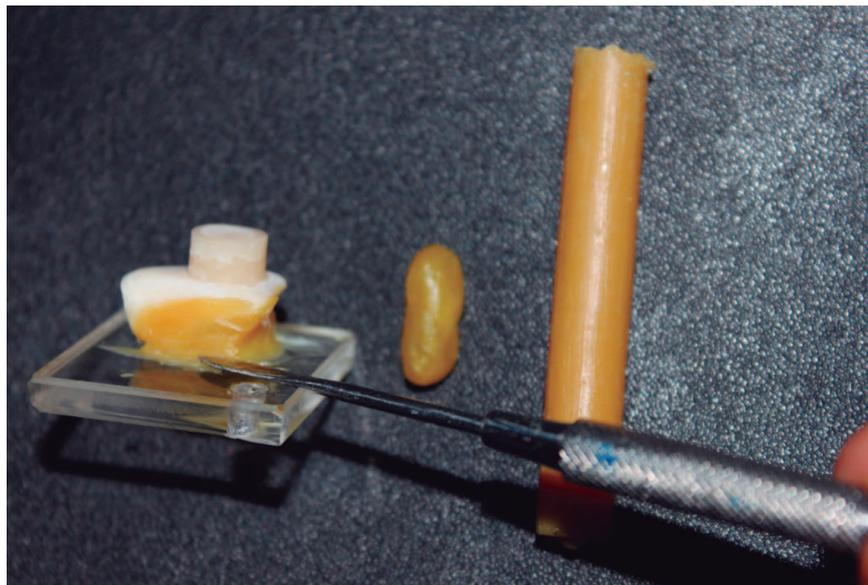
Figura 2. Los dientes se fijaron con cera vidriosa sobre una placa de acrílico, quedando la cara vestibular expuesta y paralela a la placa
