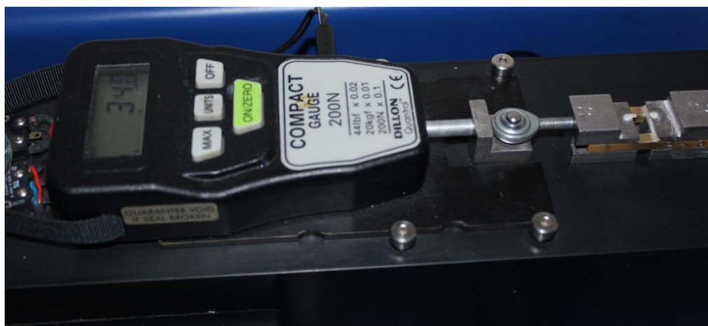
Figura 4. Prueba de microtensión, velocidad de 0.5 mm/min (Microtensiómetro (Bisco, Schaumburg, IL))
