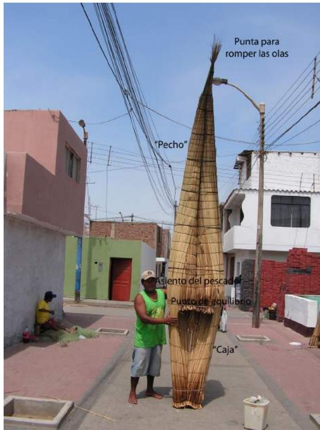
Figura 17. Balsa terminada y lista para navegar.
