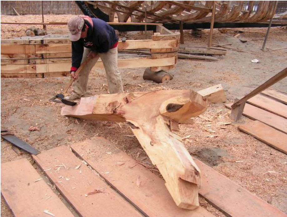
*Figura 3.* Tronco de espino en proceso de tallado para convertirse en quilla de embarcación.
