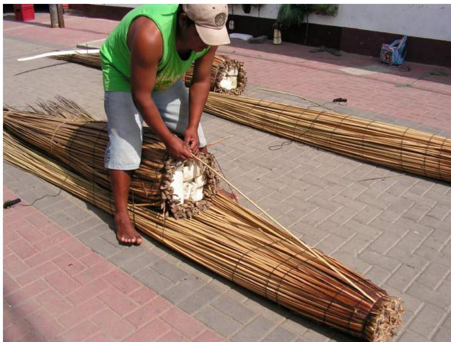
*Figura 13.* Midiendo la distancia para ubicar los bastones correctamente.
